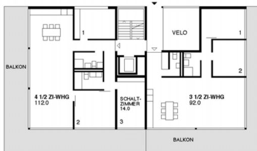
Grundriss Erdgeschoss Häuser 1 und 4
